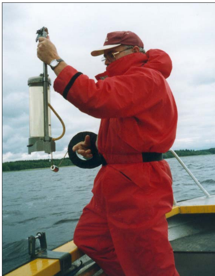
Vattenprovtagning med Ruttnerhämtare (foto: John Sandin, ALcontrol Skara)
