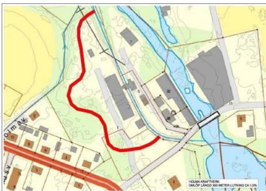
Figur 19. Förslag till omlöp förbi kraftverket vid Holma.
