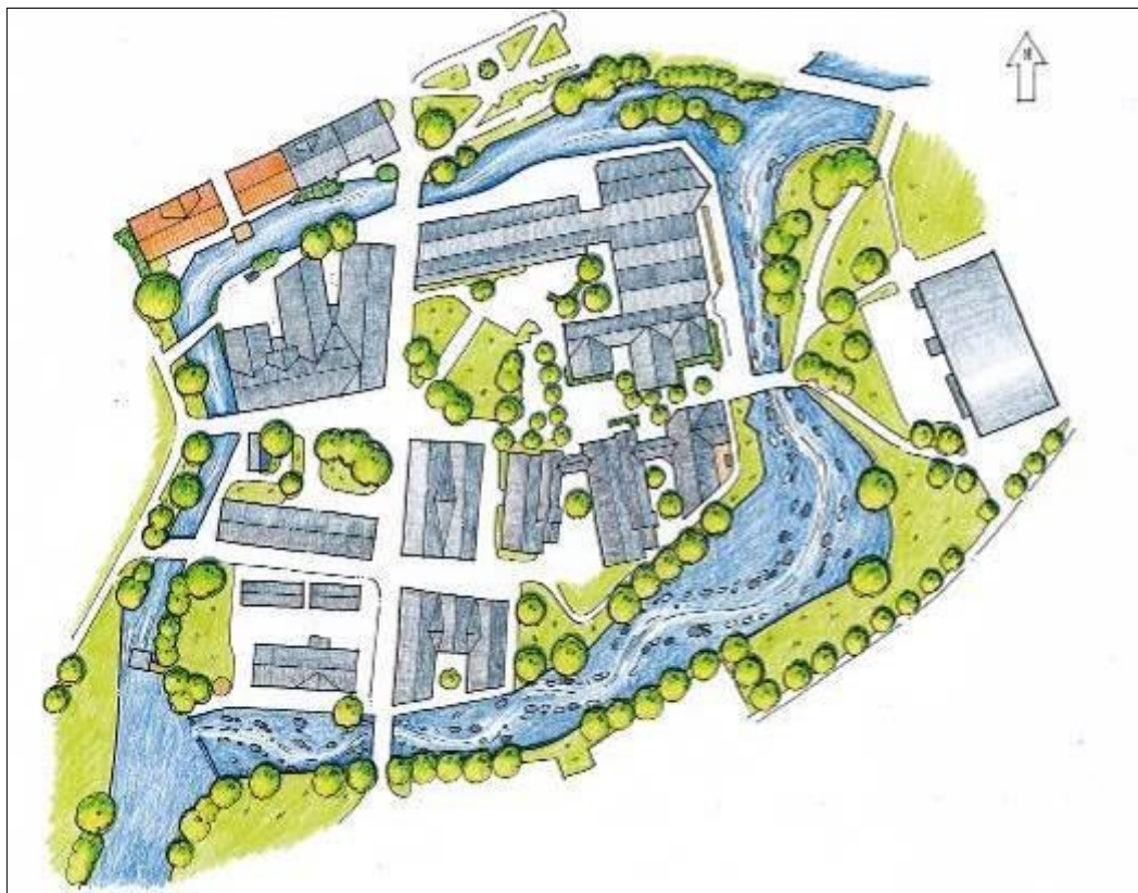
Figur 35. Illustration över förslag till stryk i högra fåran vid Vulcan B (ill. Evalena Öman). Illustrationen återges i större format i bilaga H.
