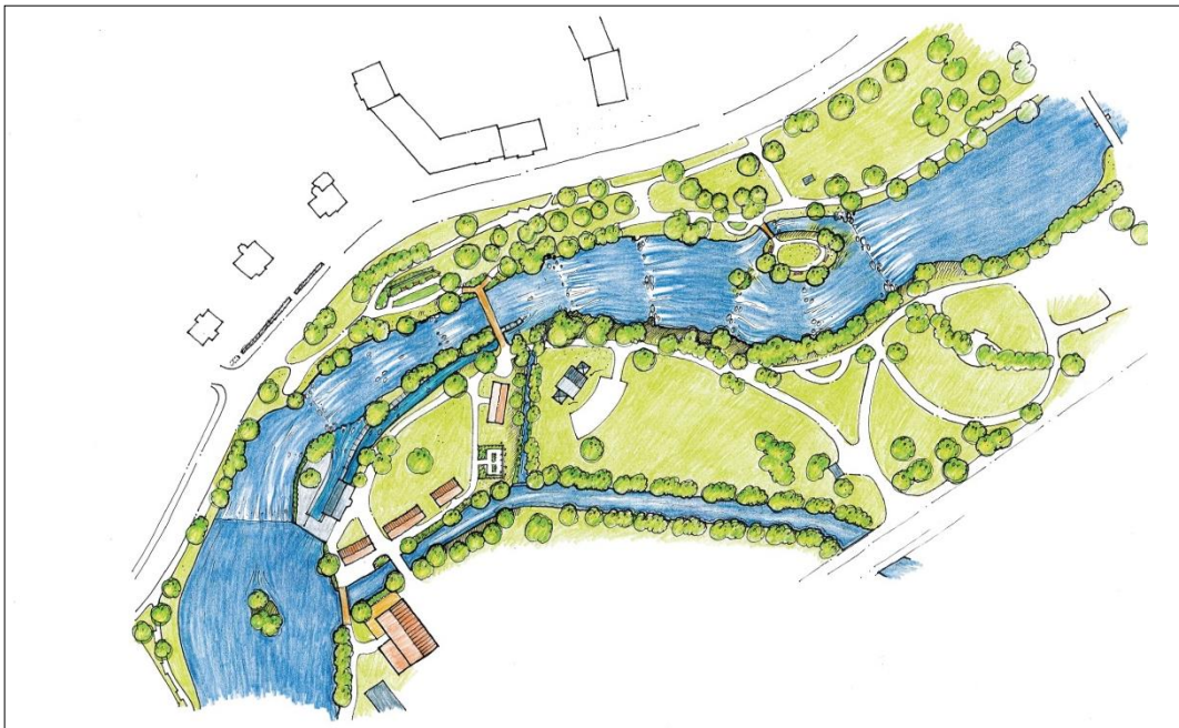
Figur 42. Alternativ 3. Illustration över förslag till slitsränna och stryk under nuvarande konsthallen vid Turbinhusön (ill. Evalena Öman). Illustrationen återges i större format i bilaga L.
