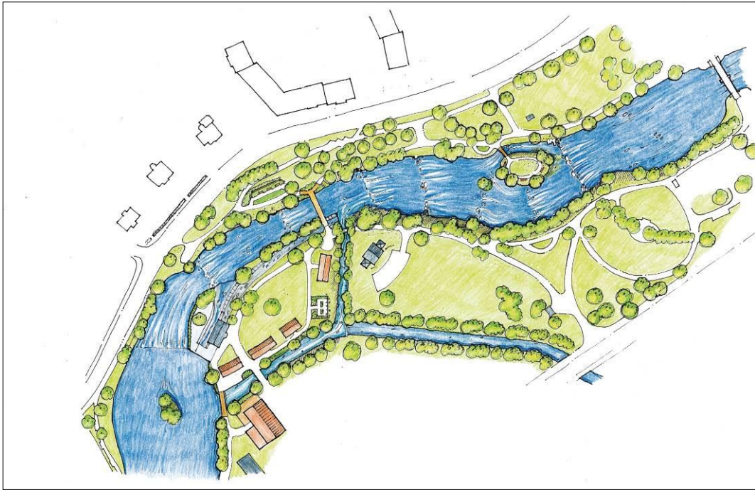
Figur 41. Alternativ 2. Illustration över förslag till omlöp samt partiell utrivning av damm i gamla intagskanalen till kraftverket vid Turbinhusön (ill. Evalena Öman). Illustrationen återges i större format i bilaga K.
