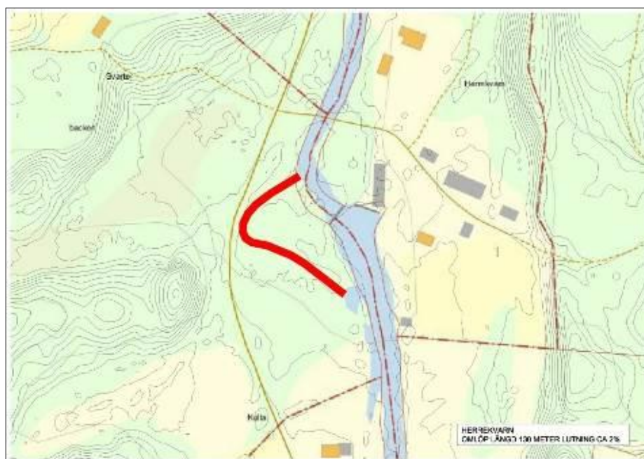
Figur13. Förslag till omlöp i anslutning till vänster strand vid Herrekvarn.
