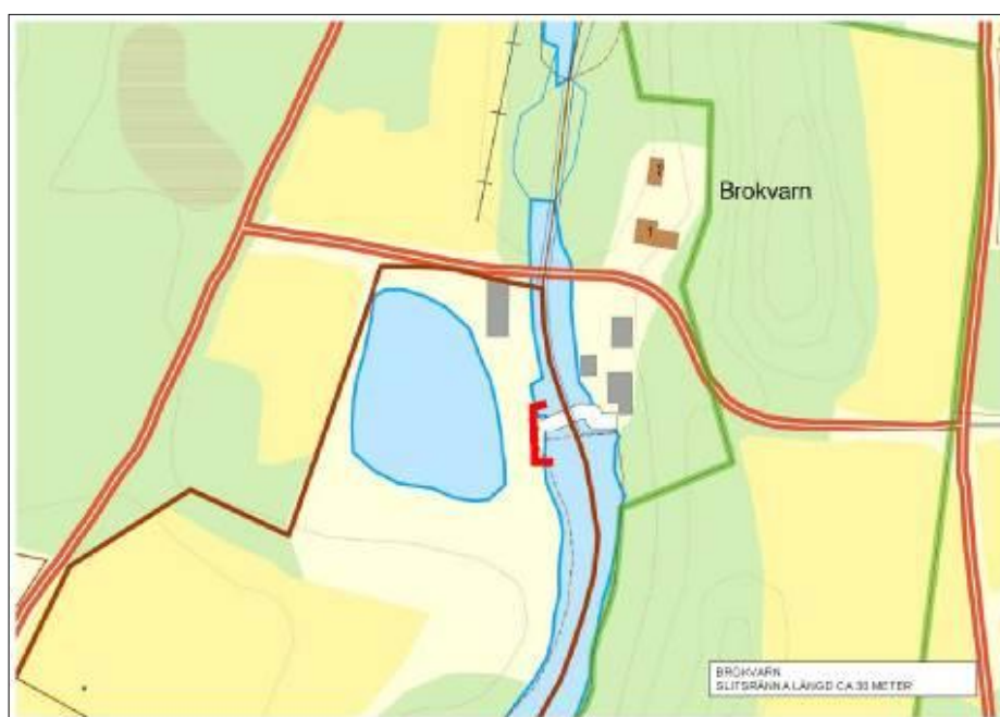
Figur 11. Förslag till slitsränna i anslutning till vänster utskov vid Brokvarn.
