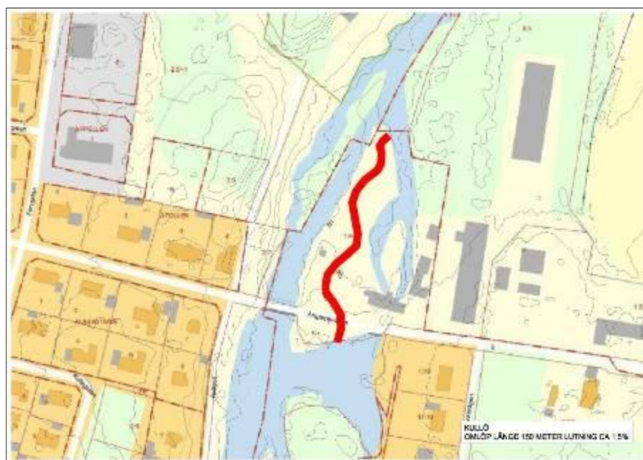
Figur 23. Förslag till omlöp förbi kraftverket vid Kullö.
