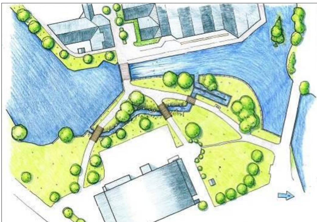
Figur 34. Illustration över förslag till slitsränna i kombination med omlöp på höger strand i högra fåran vid Vulcan B (ill. Evalena Öman). Illustrationen återges i större format i bilaga G.
